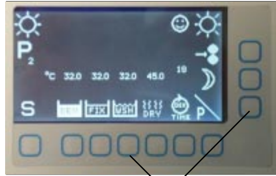
الشكل ٤ أزرار الدفع الخاصة بوضع الاحتياط على الشاشة
